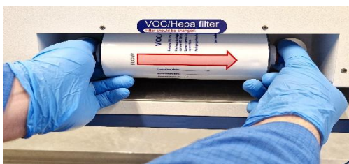
Rysunek 12.2 Procedura montażu i demontażu filtra LZO/HEPA
