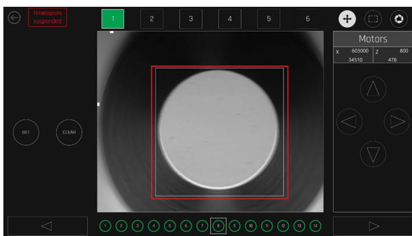
Rysunek 20.43 Prawidłowo wyregulowany widok dotka szalki
